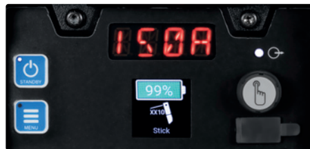
Modo de soldadura convencional con electrodos XX10
