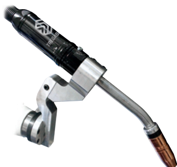
Torche MIG robotisée Tregaskiss® CA3 Torche d'automatisation standard permettant de souder des fils d'acier, d'acier inoxydable et d'autres métaux ferreux. Disponible en modèles refroidis par air et par liquide. Pour plus d'informations, voir la documentation Tregaskiss® SP-CA3.
