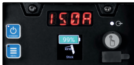
Mode de soudage à électrode enrobée XX10
