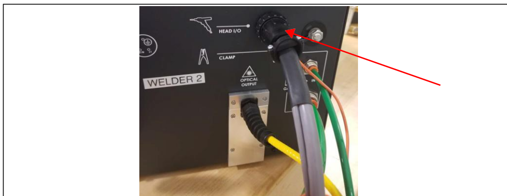
▼ Illustration 17. Connexion du câble E/S du pistolet
