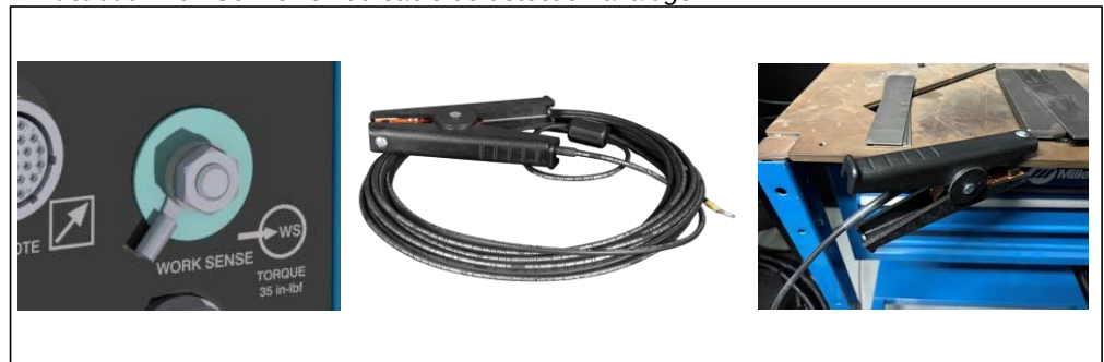
▼ Illustration 16. Connexion du câble de détection à la tige
